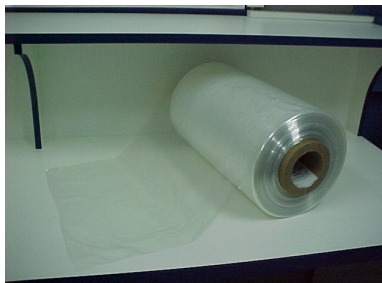
Figura 3: Embalagem terciária do guia descartável (filme poliolefinico encolhível)
